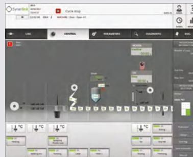
Efidrive proporciona al operador información visual constante sobre todas las actualizaciones de la máquina y sobre el estado de todos los materiales de envasado ubicados en cualquier máquina Synerlink de la línea.
